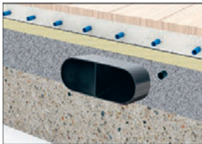
Flachkanal in der Ausgleichsschicht (nach DIN 18560-2)
